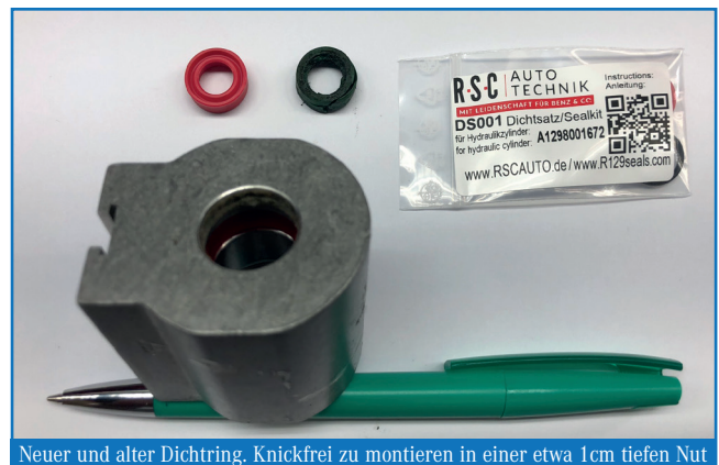
Neuer und alter Dichtring. Knickfrei zu montieren in einer etwa 1cm tiefen Nut
