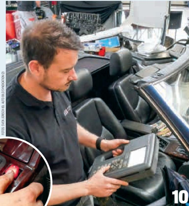
**10 ABSCHLUSS-CHECK** Sind alle Zylinder gewechselt, erfolgt am Ende die Funktionsprüfung und das Löschen des Fehlerspeichers. Die Profis brauchen für eine Komplettrevision fünf Stunden
